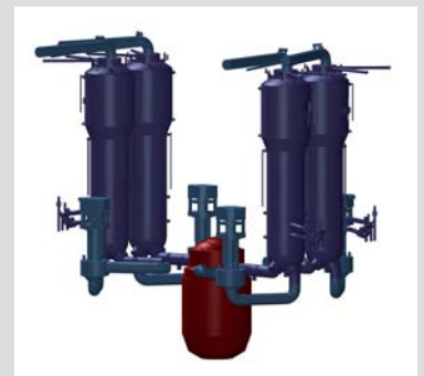
3D-Modell – erstellt auf der Basis von 3D-Laserscanning
