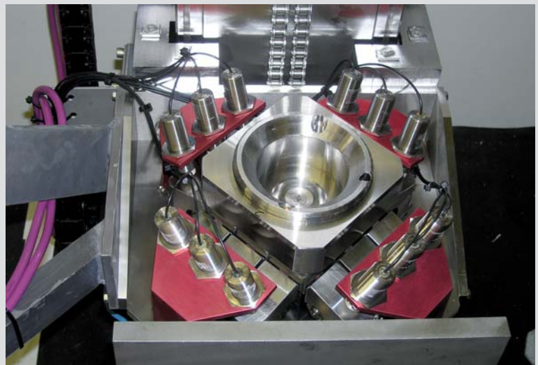
Messschlitten der KMV mit je 12 Wirbelstromsensoren und Messwertübersetzern
