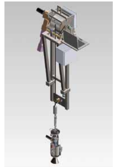
3D-Skizze des Kupplungswerkzeuges für SE-Antriebsstangen, bestehend aus Konsolwagen und Greifkopf.
